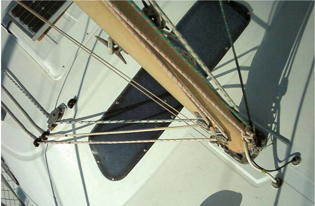
Vue générale des renvois sur le roof.
