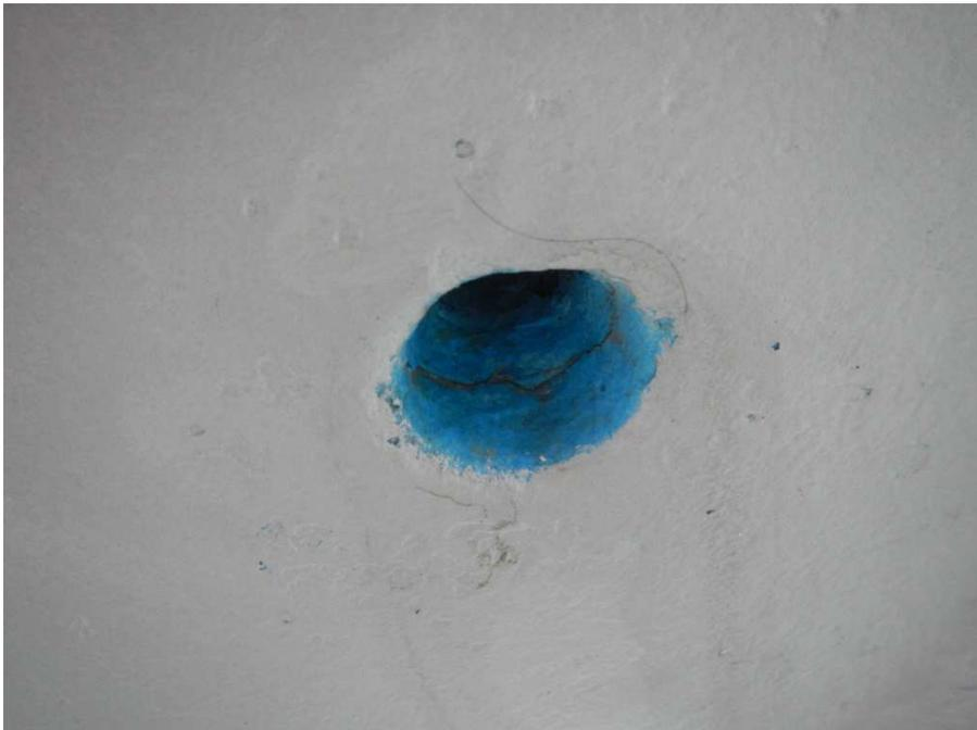
J'ai choisi de couper le tube au ras de la coque et environ 15 cm sous le cockpit.
