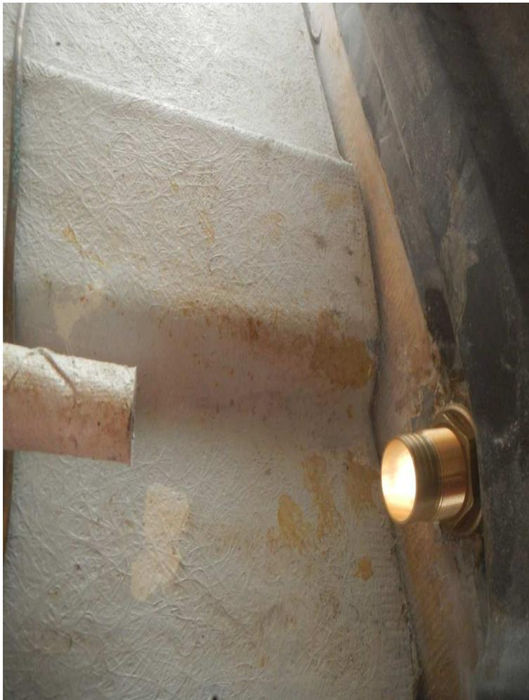
Après avoir poncé la coque et agrandir le trou de passage j'ai mis un passe coque de 45MM. En gardant les 15/20 cm de tuyau d'origine j'ai pu glisser un flexible diamètre 45 sur 15 cm et l'autre bout sur le passe coque. Avant de glisser le flexible j'ai mis du Sicaflex pour assurer l'étanchéité.
